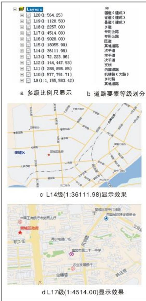
图6 多比例尺地图综合
